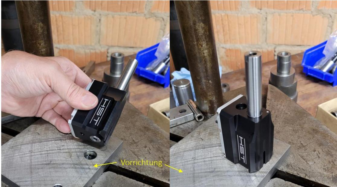
10. Pressen Sie den Lauf entsprechend der gemessenen Einpresstiefe ein. Die Einpresstiefe wurde im Kapitel Ausbau (5.1) ermittelt. **Achten Sie darauf, dass Sie den Lauf nicht durch Werkzeuge beschädigen!** *Tipp: Bauen Sie sich einen Anschlag, der die Einpresstiefe begrenzt. (siehe nachfolgende Abbildung).*
