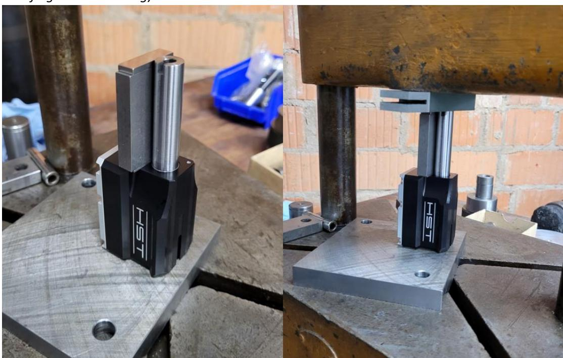
11. Kontrollieren Sie nach dem Einpressen die Tiefe und die Ausrichtung der Nut für den Auszieher.
