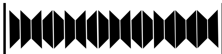
Abbildung 7.4 - Standard mit 19 Federn (maximal empfohlene Schließkraft)
